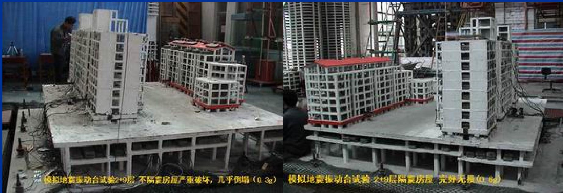
模拟地震振动台试验2+9层 不隔震房屋严重破坏, 几乎倒塌(0.3g)
