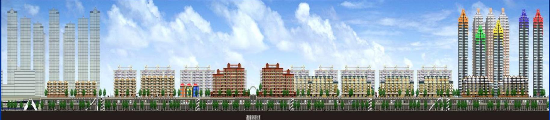
北京地铁地面枢纽站RC平台上隔震房屋大RC平台（2000米x1500米）上建造48幢9层的隔震住宅楼隔震建筑面积 480,000M<sup>2</sup>，目前世界最大隔震建筑。
