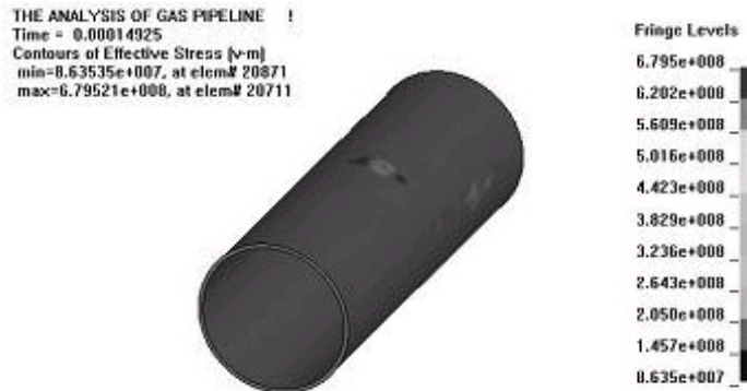
图4 管道的Von mises应力响应
