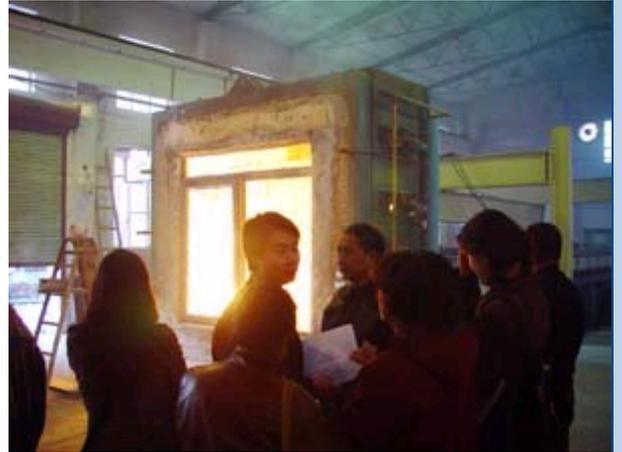
砼梁组成的试验框架内。按照标准升温曲线进行耐火性能的对比试验。试验结果显示，普通钢化玻璃在试验开始后3分钟左右，即爆裂破坏，试验炉内距玻璃100mm处的平均炉温约为450℃；铯钾单片防火玻璃系统，直到71分钟时才出现完整性破坏，此时炉内距试件100mm处的平均炉温已超过950℃。
