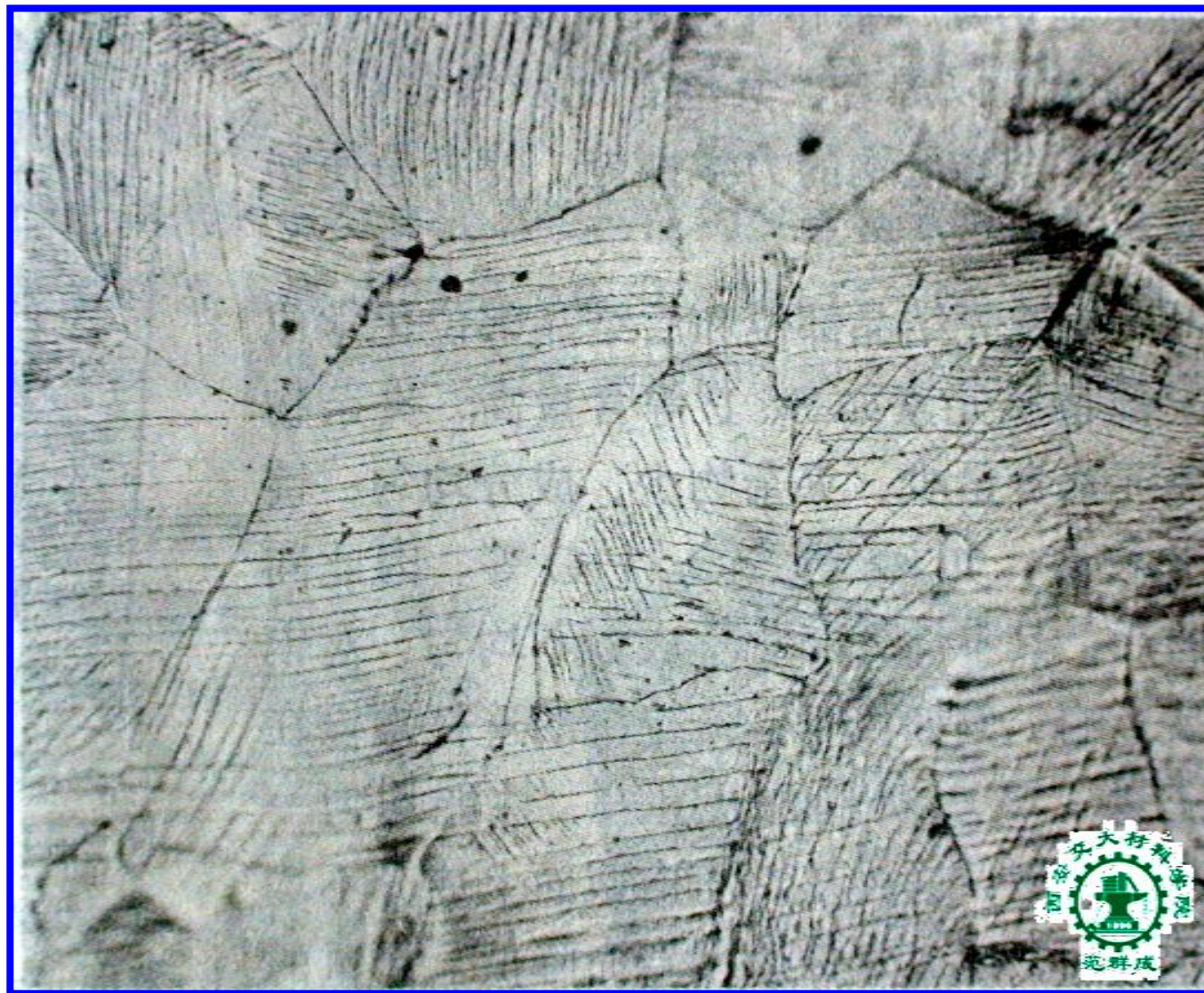
工业纯铁晶粒表面的滑移带 ×250
