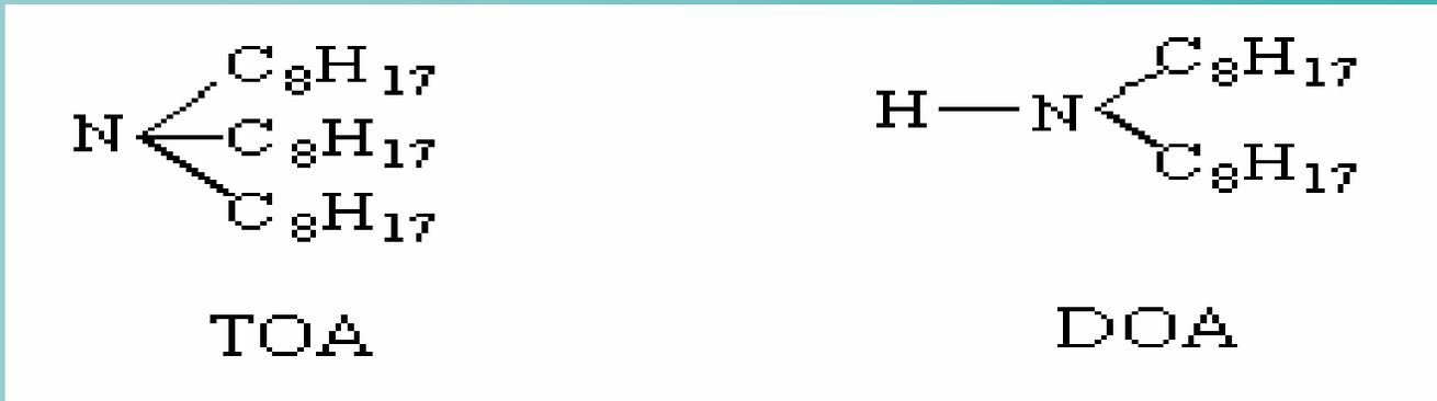
用溶解在稀释剂中长链脂肪酸从水溶液中萃取带质子的有机化合物是一个可行的过程并用于从发酵液中大规模回收柠檬酸。有机酸的可萃性取决于有机相的组成，胺萃取剂和稀释剂，典型的烷基胺类萃取剂有：
