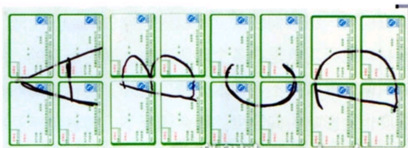
标签印刷套印准确，但模切严重套印不准，呈周期性变化 图7 模切套印比较
