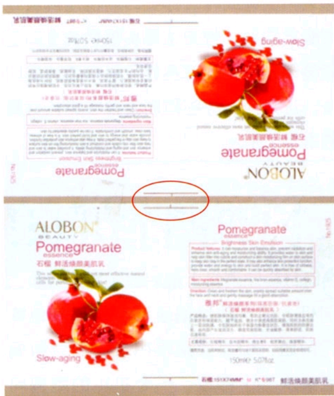
标签套印准确，但第一次和第六次印刷距纸边距离不同 图6 每个标签与纸边的距离比较
