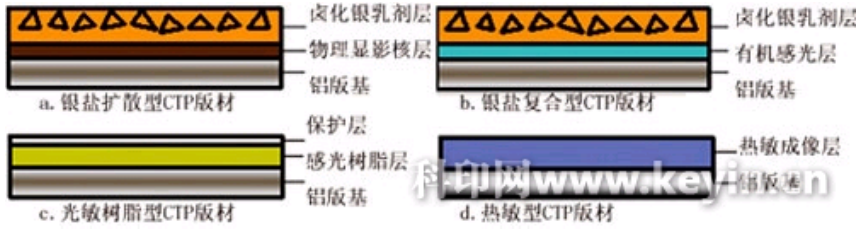
图1 几种类型版材结构示意图
