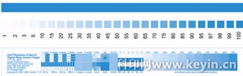
图1 实地条、梯尺、数字印版测控条
