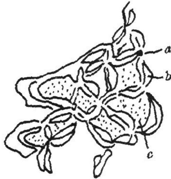
图9-14 冻胶结构示意图 a-交联点 b-溶剂化层 c-溶剂与沉淀剂
