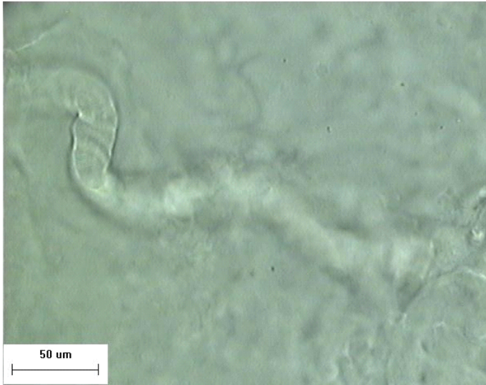
纤维素氨基甲酸酯溶液在不同温度下的热台偏光显微镜照片 a -20°C; b -5°C; c --5°C; d --10°C
