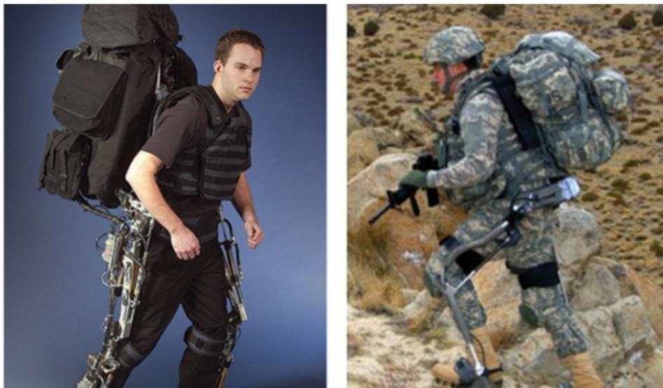
加利福尼亚大学伯克利分校研制了以液压驱动装置提供动力的可穿戴末端外骨骼BLEEX, 以及在此基础上改良的接近实战应用的HULC外骨骼, 绑缚在士兵腿上可模拟人体下肢运动, 增强士兵的负重 (最大负重100 kg) 行走能力, 目前有少部分投入于美军作战中。
