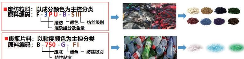
“合”: 标准化原料针对性混合配用。建立多级自动料仓, 依据需求选取不同种类原料混配再生, 根据需求选取不同的母粒, 进行白度原位调控或色度原位梯度调控, 满足使用需求; 也可充分发挥各类泡料特性, 进行泡料多元原位配色, 全量利用, 废尽其用。
