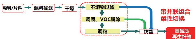
“专”：面向多领域应用的专业化定制。将废旧聚酯混杂组分原位利用，如泡料和瓶片配色、混杂体系稳定化，经过专业化定制，实现在线功能化改性、在线补色调色，可制备专业应用的有色纤维，色差及色牢度优于原生纤维，且免去后续染色工艺，在服用面料、家纺内饰、针刺土工布、车用纺织品、鞋用面料领域得到成功应用，全面满足专业应用需求。
