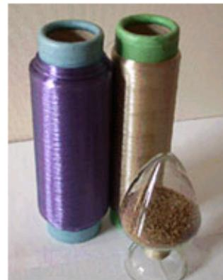
聚乙丙交酯(PGLA)切片是由乙交酯(GA)、丙交酯(LA)按一定配比共聚所得的聚合物切片，将该产品可用做可吸收外科手术缝合线、骨折内固定材料、药物缓释载体等的原料。
