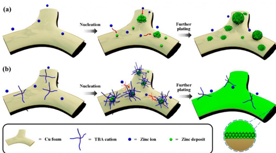
近日，中山大學材料科学与工程学院朱昌宝教授团队提出了一种具有疏锌排斥作用的电解液添加剂（四丁基硫酸铵， $TBA_2SO_4$ ）策略，在极低的添加量（0.029 g/L）下可有效抑制锌负极表面的尖端效应，从而促进锌离子的均匀沉积。原位光学显微镜、密度泛函理论（DFT）、和电化学测试表明在锌离子电
