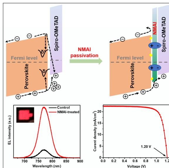
有机-无机杂化钙钛矿因其优异的光电子性能，受到全世界研究者的关注。其作为活性层制备的太阳能电池，光电转换效率已超过25%，接近单晶硅电池的最高值。然而，通过低温溶液法制备的钙钛矿薄膜通常是多晶的。多晶薄膜，在其表面和晶界处容易产生缺陷，会捕获光生电荷，导致额外的非辐射复合能量损失，限制了器件的开路电压和整体性能。钝化是一种有效减少缺陷、抑制非辐射复合的方法。路易斯碱、 $\text{PbI}_2$ 、PMMA高分子材料等被成功应用于钝化钙钛矿的缺陷。其中有有机胺盐，例如苯乙胺碘（PEAI）也被成功用来钝化钙钛矿表面，提升器件的开路电压，并获得了创世界纪录的效率。然而，PEAI处理的钙钛矿对温度敏感，在高温下PEAI本身会发生反应形成二维钙钛矿，影响器件的稳定性；此外，铵盐的钝化机制还需要更多的研究。
