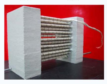
最近,我所研制成功了国内首个管型中温固体氧化物燃料电池堆。该管型电池堆采用了管型电池串并联结构,在800°C、工作电压为7.4伏时,输出电流达71.7安培,输出功率达到530瓦,并实现了电池堆的重复启动。管型电池堆技术的成功应用,为发展我国固体氧化物燃料电池分散电站和集中电站奠定了良好的技术基础。
