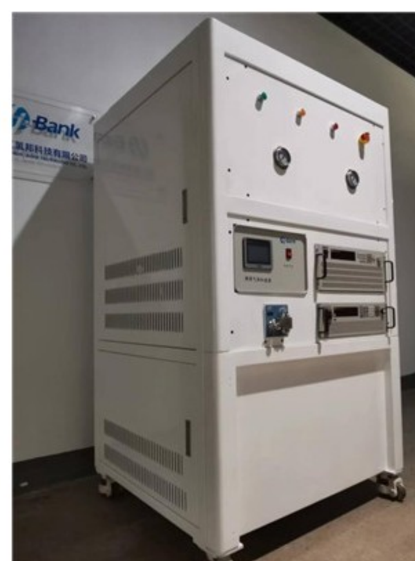
图4 5kW级的CO 2 电解与放电可逆一体机
