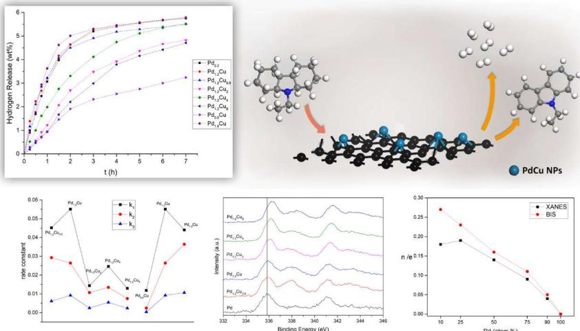
针对上述问题，西安交通大学化工学院绿色过程技术研究室（负责人：方涛教授）在前序研究的基础上，设计了一种简便温和的一锅法共还原制备得到了一系列不同配比的还原氧化石墨烯负载的双金属PdCu/rGO合金催化剂，其中Pd<sub>1.2</sub>Cu/rGO催化剂首次在453K下达到了脱氢终产物N-乙基咔唑100%的选择性，同时贵金属Pd的用量相较于该反应中常用的商业催化剂和其他课题组已报道的催化剂降低了60%以上。同时，本研究系统分析了共还原温度和金属负载量的变化对脱氢反应动力学的影响，结合一系列催化剂的表征，解释了双金属PdCu结构与性能间的构效关系。通过关联双金属PdCu纳米粒子的配比和电子结构，验证了不同配比催化剂的活性规律。这一工作首次建立了十二氢-N-乙基咔唑的宏观脱氢性能与活性组分微观电子结构间的关联，为相关有机液体储氢材料脱氢催化剂的设计提供了重要的指导和研究思路。
