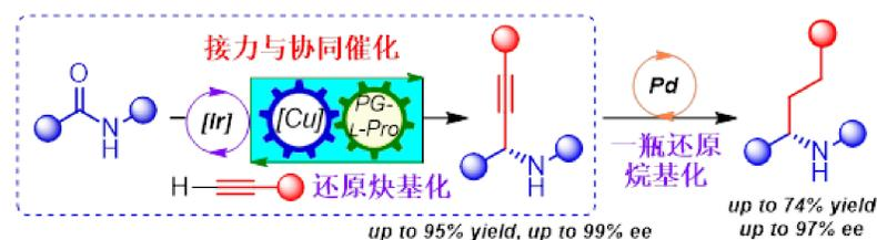
近日,黄培强教授课题组首次报道了仲酰胺的催化还原/脱氧不对称炔基化、烷基化反应。该方法基于将铱/铜双金属接力催化与有机小分子催化相结合的多重催化策略,实现了仲酰胺的催化不对称还原炔基化,以及原位与钯催化氢化反应结合进行仲酰胺催化一瓶对映选择性还原烷基化。该催化还原不对称炔基化方法对多数底物具有优良的收率和对映选择性(up to 95% yield, up to 99% ee),表现出优异的化学选择性和官能团耐受性,可兼容酮和醛等反应性更高的官能团。通过这一新策略,课题组高效地合成了活性药物分子中常见的四种 $\alpha$ -支链手性胺结构片段,实现了两种药物衍生物的后期官能化和阿片受体拮抗剂阿替卡普兰(Aticaprant)的首次催化不对称合成,从而展示了该方法的在有机合成和药物合成中的实用性。
