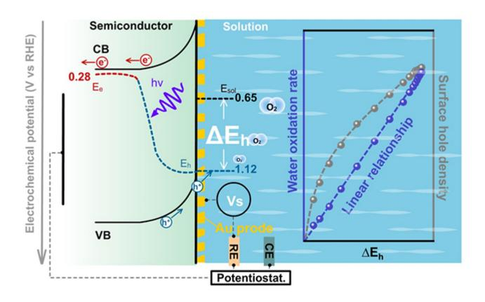
在上述的理解和认识的基础上,在液相反应条件下研究光生电荷跨越固液相界面向化学能转化的过程成为理解整个太阳能光化学转换过程的"最后一公里"。本工作聚焦于理解光催化剂表面光生电荷如何通过半导体溶液界面转移驱动水分解反应这一核心科学问题,在钛酸锶光催化剂水氧化反应过程中,利用自主研发的operando表界面电化学势测量方法,同时对光催化剂表面和溶液电化学势、电子和空穴的准费米能级、体系光电压和表面水氧化活性进行检测,解耦了光电催化水分解过程中错综复杂的电荷转移步骤与催化反应步骤,发现了全新的表面催化反应促进的电荷转移机制。团队通过定量关联揭示,这种全新的电荷转移机制引起的光催化剂表面与溶液之间的电势差是界面电荷转移的本质驱动力,且这种驱动力与界面电荷转移速率具有线性规律。进一步深入研究发现,这种线性规律对光生少子界面电荷转移和利用具有普适性,区别于Bulter-Volmer理论描述的电催化过程电压与界面电荷转移速率之间的指数规律。其内在原因是在光电催化过程中光照和外加偏压只是改变参与反应的电荷浓度,不改变参与反应的表面电荷的能量和反应坐标。这些结果建立了对光催化界面电荷转移理论的全新认识。
