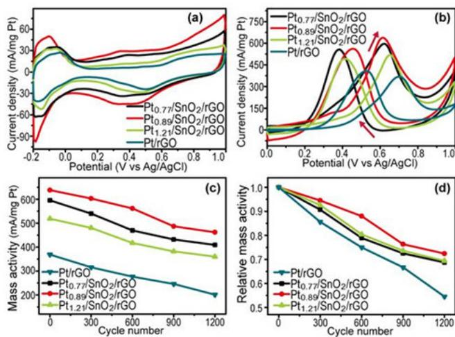
图2. 各催化剂在 (a) 0.5 M 氮气饱和的H<sub>2</sub>SO<sub>4</sub>溶液以及 (b) 0.5 M H<sub>2</sub>SO<sub>4</sub> + 0.5 M CH<sub>3</sub>OH溶液中的循环伏安特性曲线；(c和d) 各催化剂对甲醇氧化催化稳定性的测试结果。
