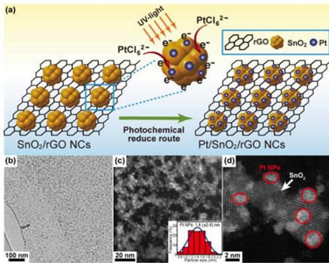
图1. Pt<sub>0.89</sub>/SnO<sub>2</sub>/rGO催化剂：(a) 形成过程示意图；(b) 低倍TEM照片，(c和d) HAADF-STEM照片，(c) 中的插图为Pt纳米颗粒的粒径分布直方图。
