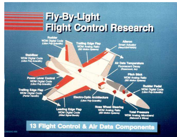
智能机翼——分布式光纤传感系统在航空航天领域的应用
