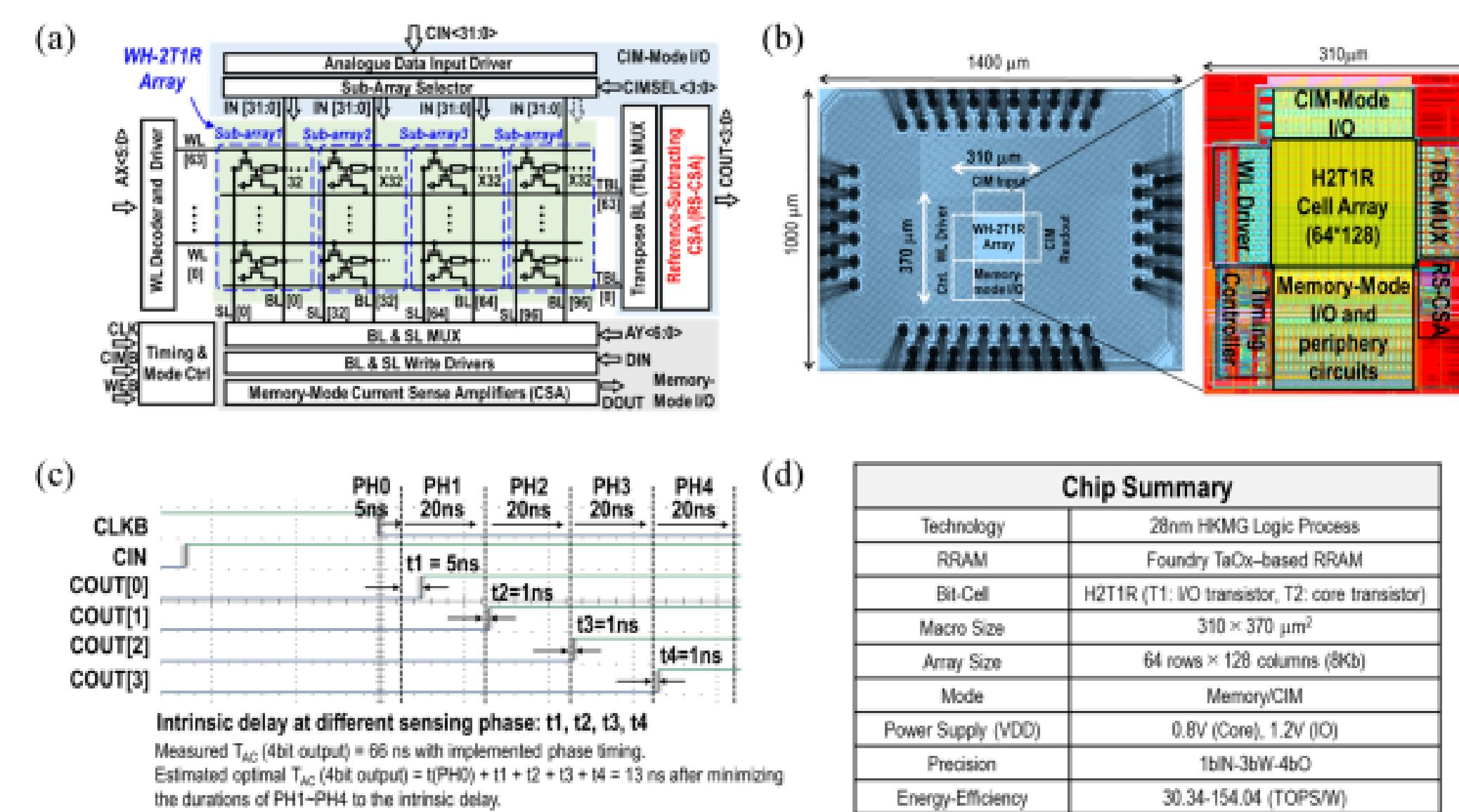
(a) 基于RRAM的存内计算芯片结构框图；(b) 芯片晶圆照片及版图；(c) 芯片测试数字波形；(d) 芯片参数
