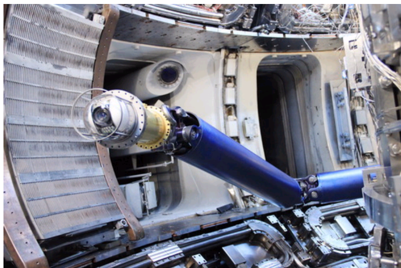
EAST真空室内部遥操作监测系统
