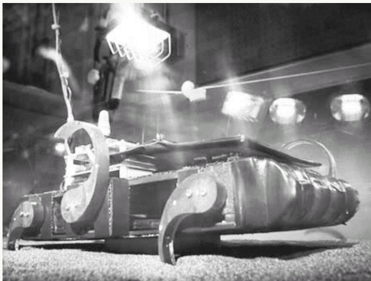
模拟沙漠动物的SandBot能够迅速穿越沙地。（图片提供:Chen Li等）
