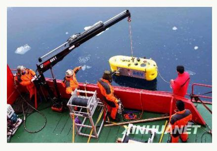
此图片显示在北纬84度北冰洋海域,中国第三次北极科考队队员用缆绳将水下机器人缓慢放入水中。(崔静摄)
