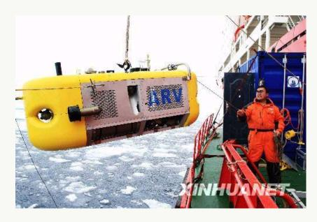
此图片显示在北纬84度北冰洋海域,一名中国第三次北极科考队队员协助将水下机器人拉出水面。中国自主研发的首个自主与遥控混合作业模式水下机器人"北极ARV",日前在北纬84度北冰洋海域成功完成冰下调查。这是中国水下机器人首次在如此高纬度开展冰下调查工作。(崔静摄)
