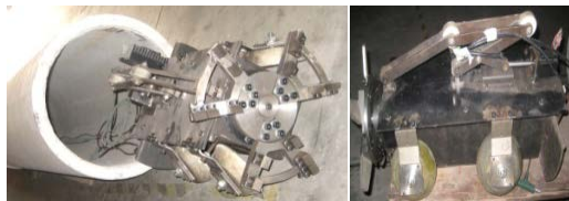
Figure 6. The pipeline dredging robot prototype 图 6. 管道清淤机器人样机
