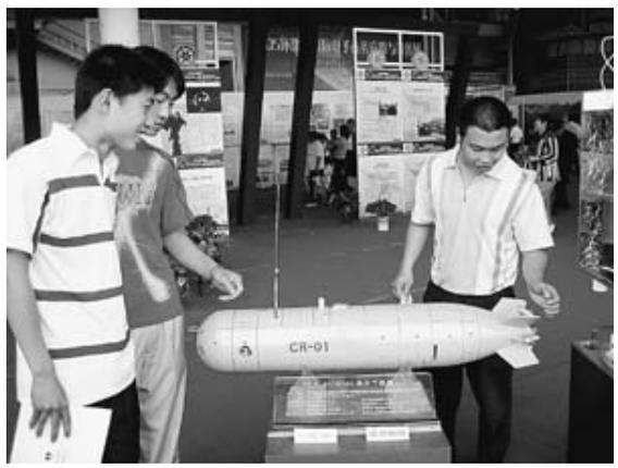
5月20日，在廊坊举办的“东北亚暨环渤海国际商务节”上，几位青年人在观看水下机器人模型。这个由中国科学院一家研究所研制成功的“CR—01—6000米水下机器人”，工作水深6000米，续航能力10小时，能拍摄照片3000张，具备海底摄像、海底勘查等多项科研功能。
