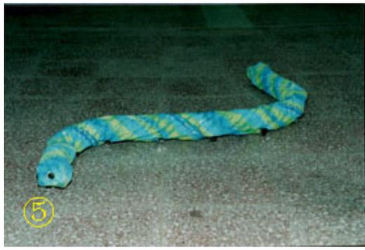
沈阳自动化所开拓仿生机器人技术新领域，开发出一种具有环境适应能力的蛇形机器人，它的头部装有微型摄像机，可以实时采集现场图像并无线传输发回监控台；它有多个关节，行走速度最快可达每秒0.4米。它可用于危险物品探查、洞穴探查方面，应用前景广泛。
