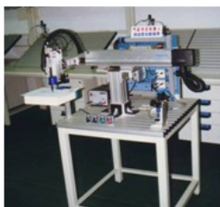
图1自主研发精密加工气动机械手
