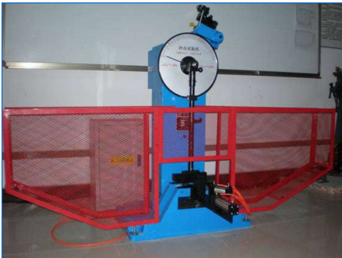
● JBW-300Z微机屏显常温自动冲击试验机
