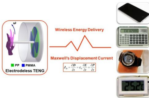
基于麦克斯韦位移电流的无线电力传输及驱动便携式、可穿戴式电子设备示意图
