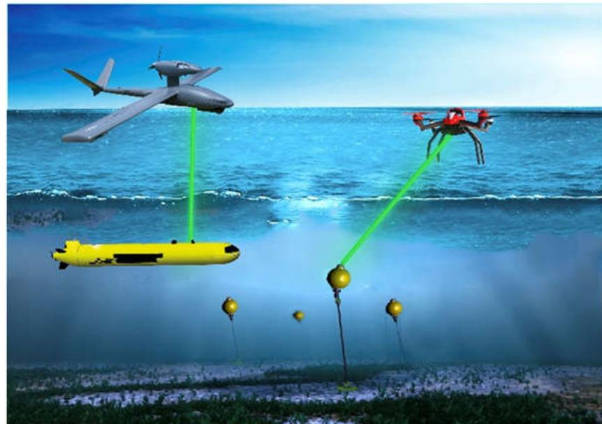
现有关于无线激光对潜通信的研究大都是理论分析，缺少实验证。美国海军与美国国防研究远景规划局成功进行了多次海上大型蓝绿激光对潜艇通信实验，主要利用激光通信在军事上的安全性优势，并非以高速数据采集为主要目的。依托浙大舟山校区先进的涉海实验条件，本研究首次对高速激光对潜通信上行和下行链路的可行性进行了实验证，实现了26米（空气中5米，水下21米）的无线数据传输，数据速率高达5.5Gbps，为未来实现复杂海况下更长距离的无线激光对潜通信研究打下了基础。
