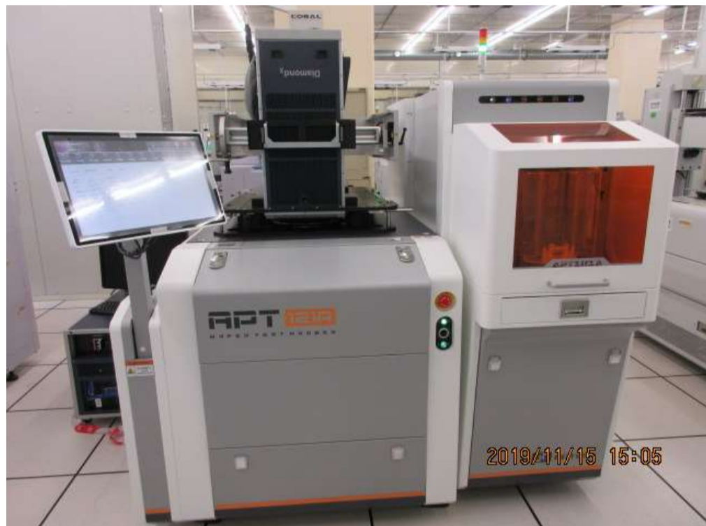
12寸全自动晶圆探针台在Fab测试
