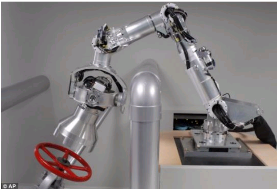
很多人将阿西莫视为一个奢侈的玩具，为了改变这种想法，丰田利用阿西莫采用的一些技术研发出机械臂，可用于打开和关闭福岛第一核电站的阀门
