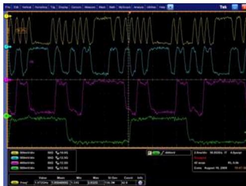
图2 4GHz 4-bit的超高速ADC的测量结果
