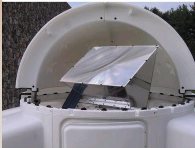
美国IBM日前发布了运用大型聚光透镜和LSI用冷却系统提高聚光型太阳能电池（Concentrator Photovoltaic, CPV）发电效率的技术。使用该技术，可大幅削减太阳能发电设施的建设及运营成本。
