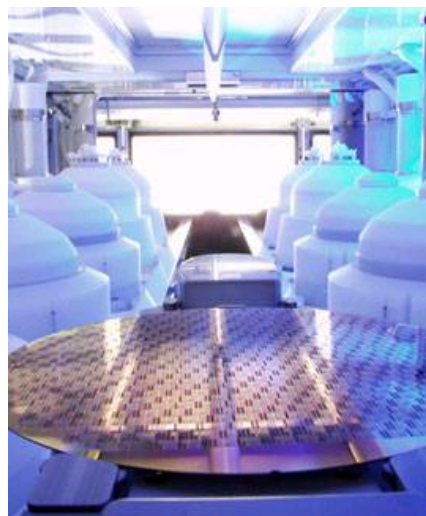
Semitool的Raider ECD (铜电镀) 工具用于晶圆级封装中。
