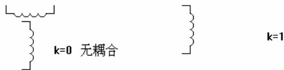
一般地：传输功率或信号(或变压器)， $K$  值越大越好；仪表间的磁场干扰， $K$  值越小越好，必要时要加以屏蔽。
