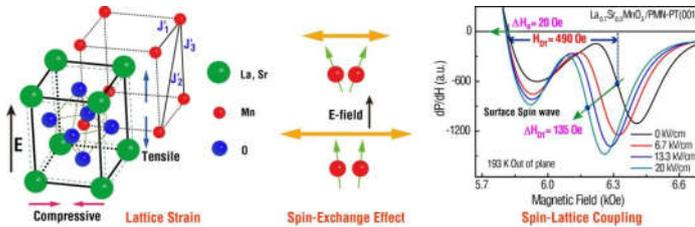
近日，西安交通大学电信学院刘明教授课题组利用多铁复合材料耗能低、响应快、便于集成等优点，运用电压脉冲来实现对于自旋的调控，进一步提升了自旋电子器件的整体性能，为新型磁电自旋器件的设计和研发打下了基础。该成果在外延多铁异质结中利用电子顺磁共振技术研究界面条件对自旋波激发模式的影响，通过电场对界面应变的调控实现了对自旋波激发模式以及自旋波变化的临界角的调控，并提出了新型的自旋-晶格耦合模型来解释电场调控自旋的实验现象，为利用电场调控电子自旋的进一步研究提供了实验和理论依据。
