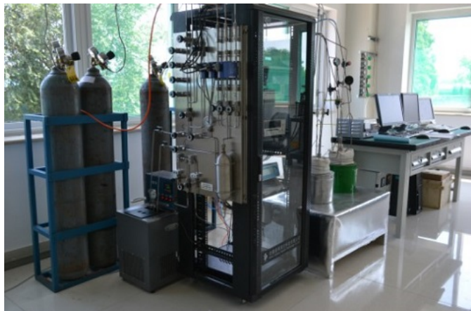
氧测控实验系统测试平台
