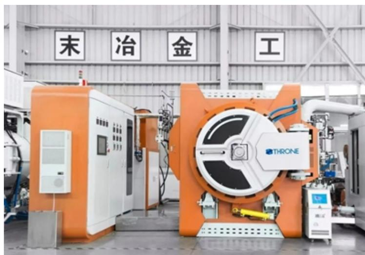
热等静压机以氩气和氮气为介质，在高温高压密闭容器中对其中的粉末或待压实的烧结坯料均等施加各项压力，从而形成致密度高的坯料，常被广泛应用于硬质合金、不锈钢、铁基合金等粉末冶金领域。作为放射性碘废物处理中试规模冷实验台架的重要后端设备，热等静压机可将装有碘废物和添加剂的密封包套进行高温高压处理，使包套内的碘废物和添加剂反应生成陶瓷固化体，同时使熔融状态的陶瓷体在高压作用下致密化。
