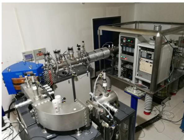
1月25日，由原子能院核物理所独立设计制造的 $^{14}\text{C}$ 小型加速器质谱（AMS）系统实现 $^{14}\text{C}$ 高灵敏、高精度测量，其灵敏度为 $^{14}\text{C}/^{12}\text{C}=5\times 10^{-15}$ 、精度为0.6%，达到国际同类设备水平。
