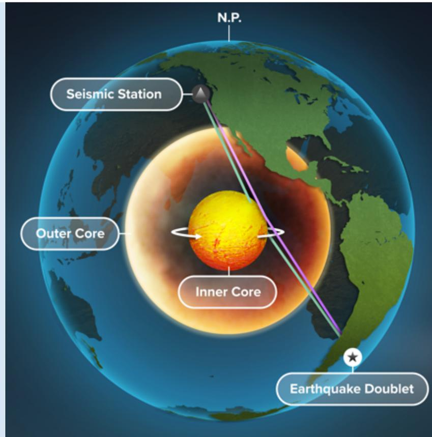
利用同一地点不同时间发生的重复地震探测内核变化的示意图。地震（南美外海）产生的波通过内核反射（紫色射线）或者透射（绿色射线）返回地表（中亚）。研究表明地震波变化主要来自穿过内核的透射波波，内核差速旋转(白色箭头)为最简单和合理的解释。（制图受Michael Vincent帮助）。
