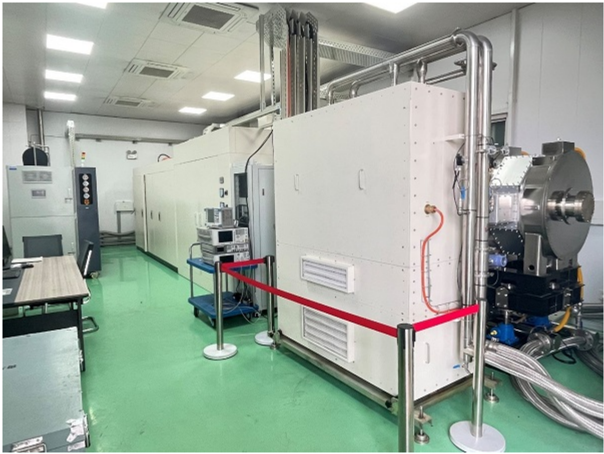
图2：高梯度、大带宽、快响应油冷磁合金高频系统
