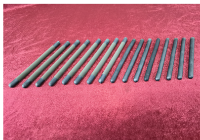
实验室小批量制备的管式电解池及其制氢稳定性测试
