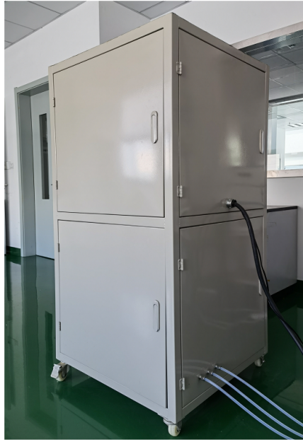
集成的kW级电解制氢样机及模块运行稳定性结果
