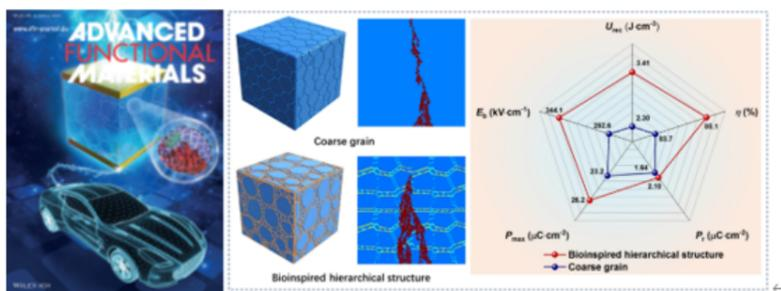
汪宏教授课题组从仿生工程的视角出发, 在BaTiO<sub>3</sub>-Bi(Mg<sub>0.5</sub>Zr<sub>0.5</sub>)O<sub>3</sub>基体中设计开发出了一种具有类树莓形态的多级核壳结构的储能陶瓷材料, 突破了传统核壳结构复相陶瓷以牺牲部分极化强度为代价的击穿场强增强策略, 成功实现了极化强度与击穿场强的协同优化, 从而实现储能密度的极大提升。该工作通过对类树莓结构复合陶瓷在纳米尺度上的界面组成、分布状态与宏观性能(极化强度、击穿场强)之间内在关系的深入探索, 并结合有限元仿真技术对击穿过程的动态直观解析, 深刻揭示了该结构对储能性能的增强机制。最终, 在BT-BMZ基全无机树莓结构纳米复合材料中获得了3.41J/cm<sup>3</sup>的储能密度与85.1%的储能效率, 并实现了储能性能在30~150°C温度范围内的超高稳定性。
