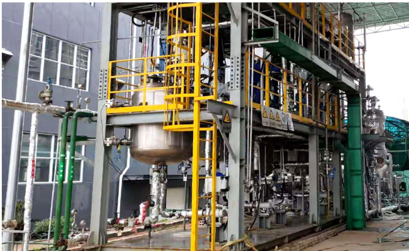
肼是一种常用航天推进剂，也是一种温和的还原剂。硝酸体系中，在合适催化剂作用下肼能够还原六价铀制备四价铀。2018年底起，该团队与中国原子能科学研究院放射化学研究所合作，开展硝酸体系肼催化还原制备四价铀技术研究开发工作。经过近两年的研究，该团队完成了系列工艺研究，开发出了高活性高稳定性工业催化剂、60kgU(IV)/d反应器样机及成套工艺，同步完成了商业化后处理厂规模的成套装置的设计加工。催化剂目前已稳定运行超过3200小时，实验仍在进行中。
