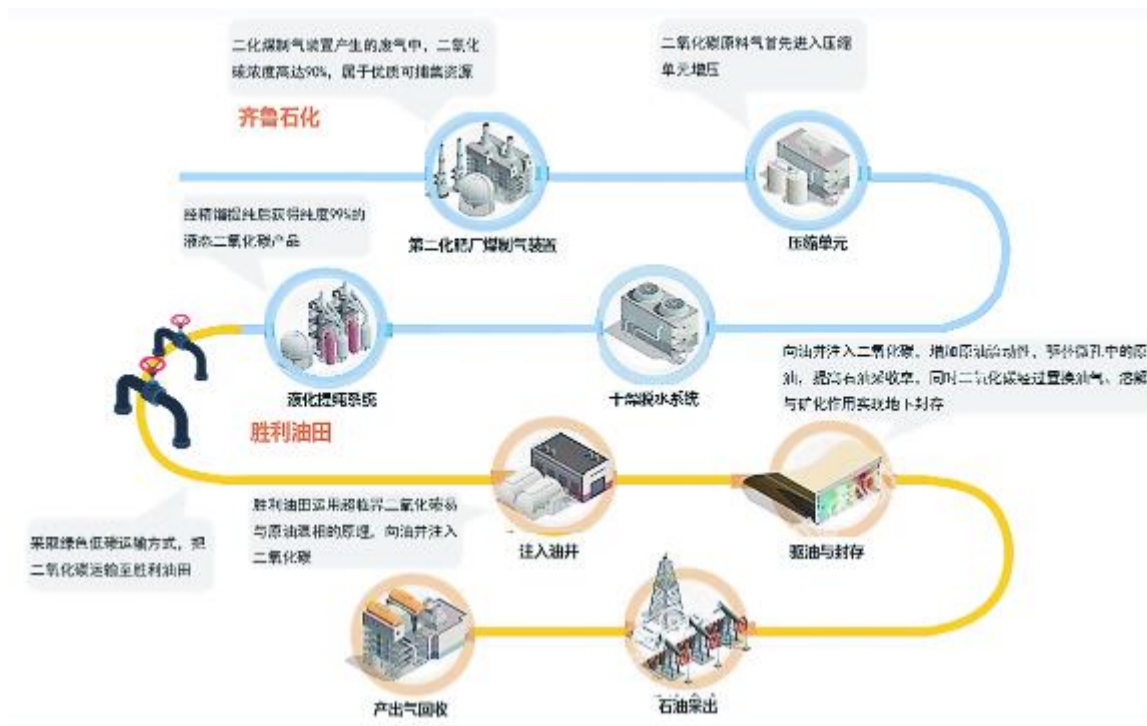
齐鲁石化-胜利油田CCUS项目流程图
