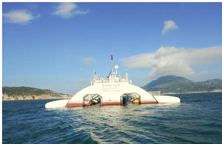
鹰式波浪能发电装置“万山号”海试进行中
